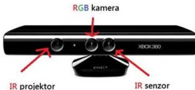
Slika 2: Lokacije IR projektora i senzora na Kinect-u
